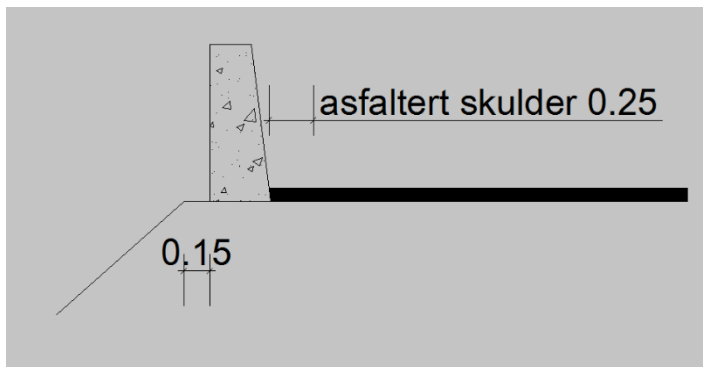
Figur 18 Plassering av betong rekkverk
